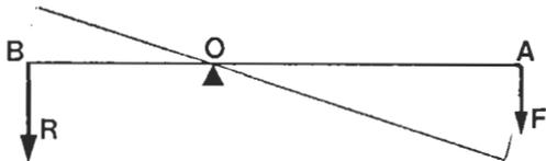
Si imaginamos la acción de F en A y la resistencia R en B, el trabajo realizado por F al rotar el punto A en torno al fulcro O se utiliza en elevar la resistencia, es decir, uno se convierte en el otro.
